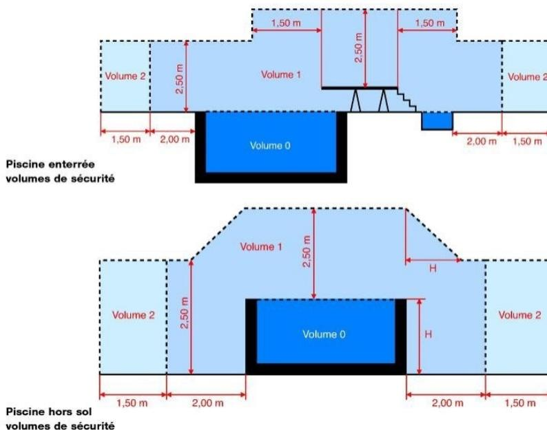
**Le volume 0 (intérieur du bassin) :** aucun appareillage n'est autorisé à l'exception de ceux alimentés en courant très basse tension (TBTS), soit 12 volts alternatif ou 30 volts continu.
