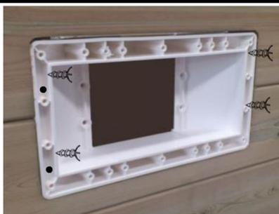
Insérez l'élargisseur par l'intérieur de la piscine. Percez 4 trous dans l'élargisseur au moyen d'une mèche à métaux, puis vissez-le dans le bois au moyen des vis inox 5 x 25 de la valisette visserie.
