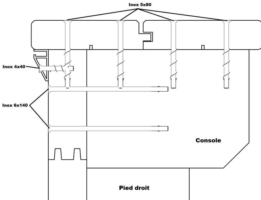
Positionnez d'abord les planches du tour intérieur (côté eau), puis le tour extérieur. Placez ensuite les vis 5 x 80 de la façon suivante (points noirs sur le plan ci-dessous):
